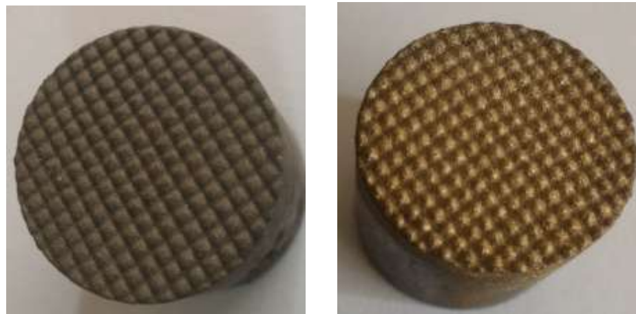
Рис. 6.1 Загальний вигляд зразків з дискретно-фрагментованим ГТН-покриттям, сформованим плазмено-дуговим напилювання. Матеріал покриття: а – сплав ВКНА; б – бронза БрА-7.
